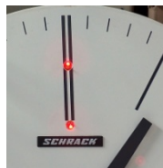
Bildtext: Nahaufnahme – optische Positionserkennung
